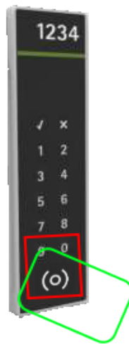
Abbildung 1.2 – LSW mit RFID Lesefeld (rot) und Transponderkarte (grün)
